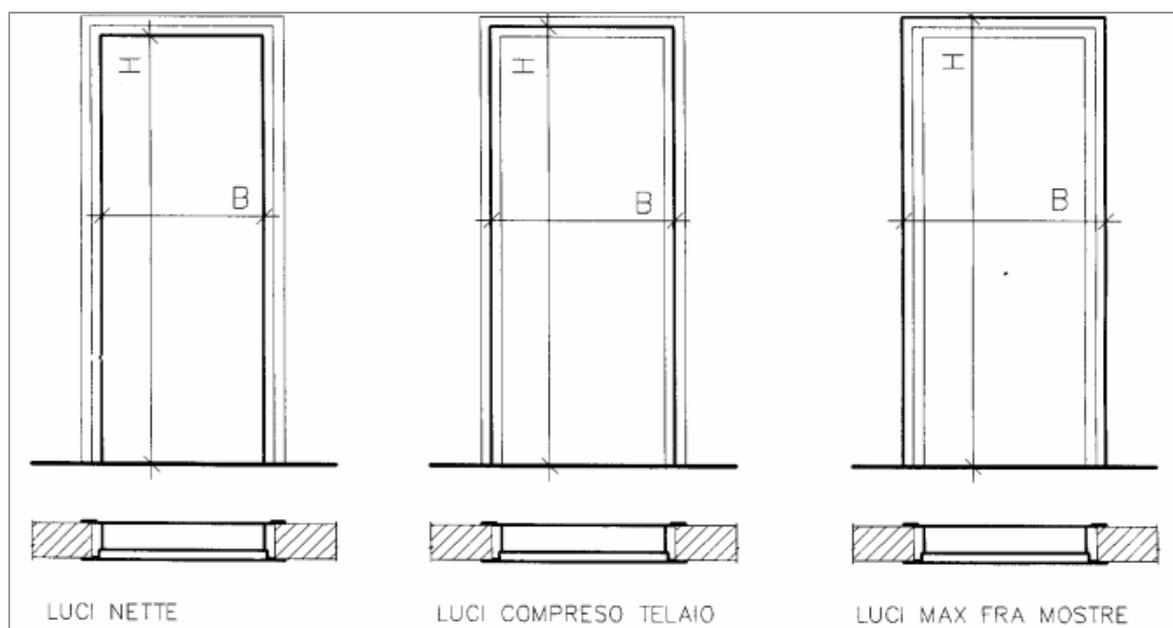
Fig. 34.2. – Misurazione delle superfici degli infissi
