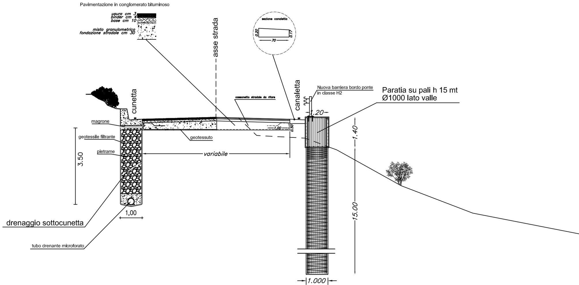
PARTICOLARE SEZIONE TIPO PARATIA SU PALI IN C.A. - SCALA 1:100
