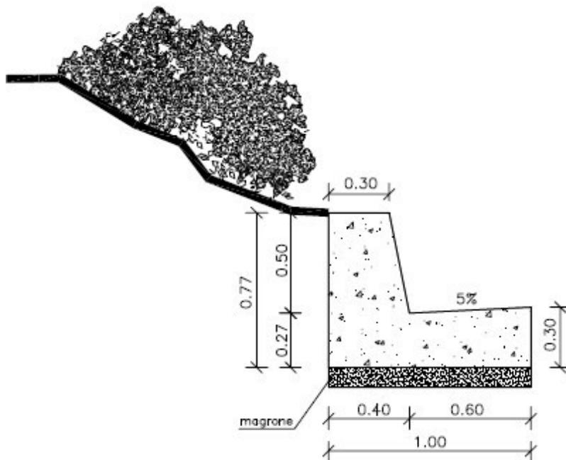
PARTICOLARE SEZIONE STRADALE TIPO CON DRENAGGIO SOTTOCUNETTA – SCALA 1:50
